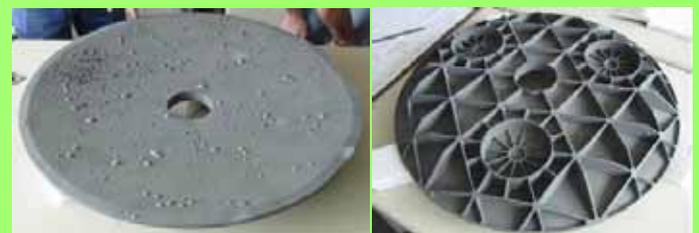
図7 6セグメントを結合した700mm C/SiC試験鏡(Si含浸後)
