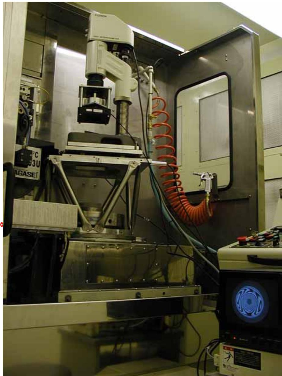
加工機上での干渉計による形状測定
